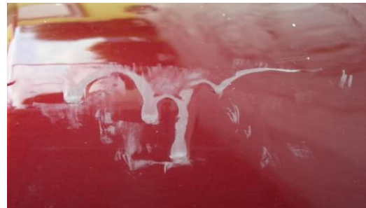
Descuelgue, producido por una excesiva aplicación de producto.
