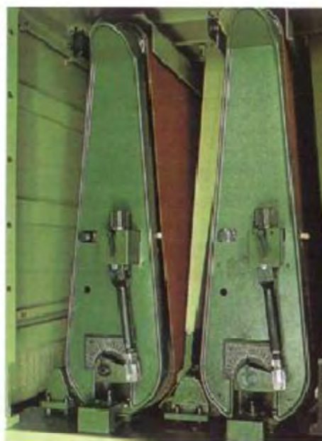
Lijadora de banda ancha de rodillo de contacto
