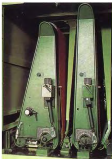
Lijadora de banda ancha de rodillo y barra de presión
