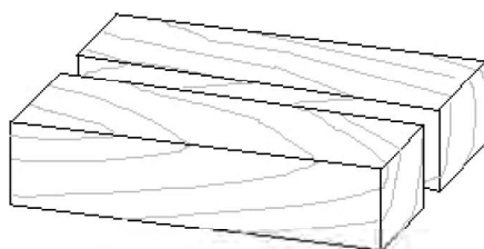
Corte al hilo, longitudinal o hendido
