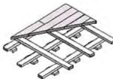
Entarimado tradicional sobre doble enrastrelado flotante
