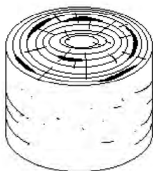
Colainas o acebolladuras
